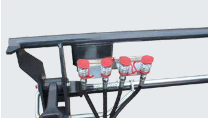
3-ioji ir 4-oji valdymo grandinės (čia – įstatomoji jungtis) Jos skirtos, norint paprastai valdyti hidraulinius padargus, pavyzdžiui, siloso žnyplės, ritinių griebtuvus ir ritinių keliamąjį krautuovą.
