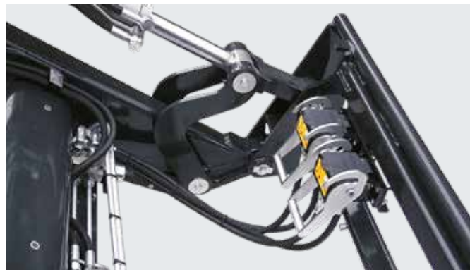
Kad būtų galima dar greičiau prijungti hidraulines linijas, padargus taip pat galima primontuoti naudojant „Hydro-Fix“ jungtis.
